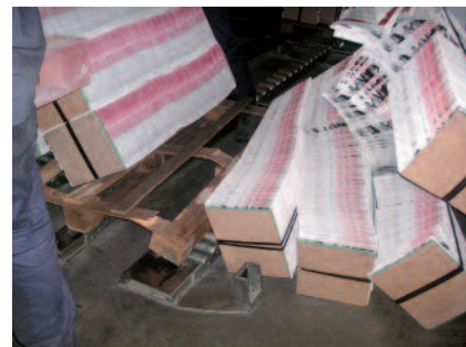
La consecuencia de utilizar paletas en mal estado puede ser la aparición de daños substanciales en el producto impreso y un posible riesgo de accidentes. Foto: Muller Martini
