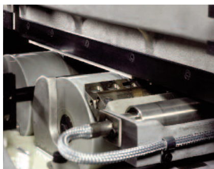
Estación de cola "hotmelt". Foto: Muller Martini
