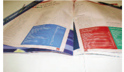
Separación a lo largo de la línea de pliegue.
