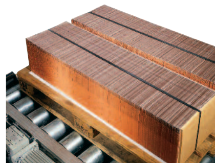
Las barras o bloques bien preparados tienen menos probabilidad de ser dañados al paletizar. Foto: Muller Martini
