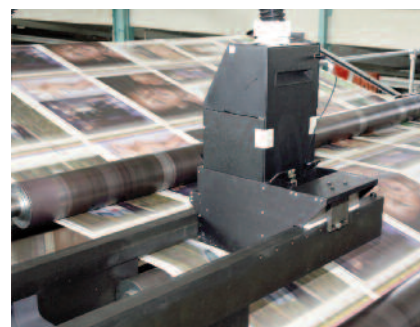
Los sistemas de impresión complementaria en inkjet se integran fácilmente en las rotativas offset y en los equipos de acabado en banda de forma que los impresores pueden aprovechar sus equipos existentes añadiendo valor para actividades de marketing directo y a otros trabajos y amplían con ello las oportunidades de negocio. Foto: Kodak
