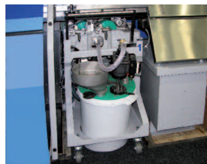
Estación de cola fría con recipiente integrado de cola. Foto: Muller Martini
