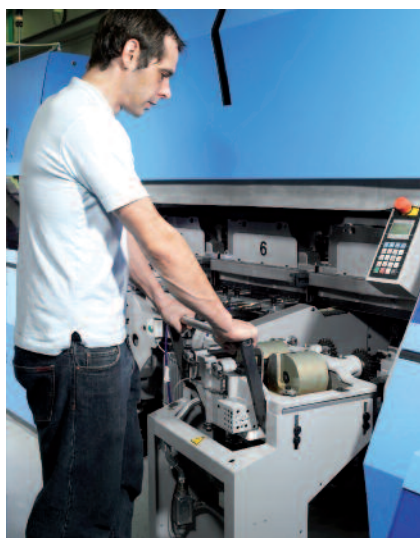
Gruppo di incollatura intercambiabile in una linea di brossura. Foto: Muller Martini
