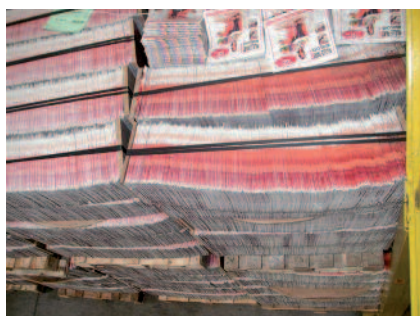
Esempio di stecca di qualità scadente con segnature disallineate e imbarcate a banana. Foto: Muller Martini
