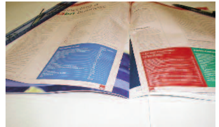
Spaccatura lungo la linea di piega. Foto: SCA
