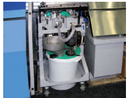
Sezione di incollatura a freddo con vasca colla integrata. Foto: Muller Martini
